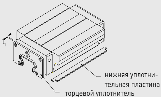
без обозначения: стандартное исполнение (торцевой уплотнитель + нижняя уплотнительная пластина)
